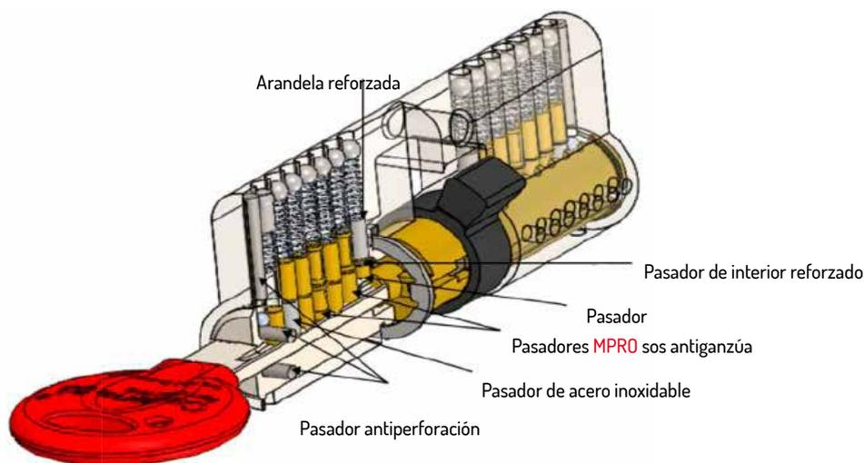
Si se llegara a partir el cilindro por la zona de la rotura controlada, **el bombillo mantiene sus propiedades anti-taladro, anti-ganzúa y anti-bumping,**
