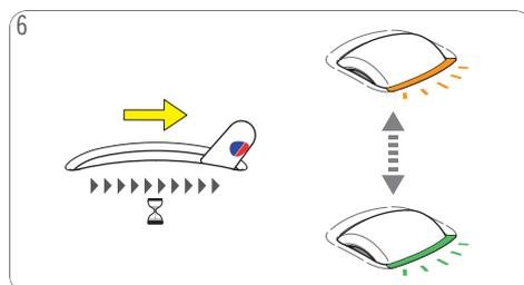
6 Empuje y mantenga la palanca de selección en la posición «CALIENTE» durante 10 segundos. Las luces del display de barras se apagan progresivamente.
