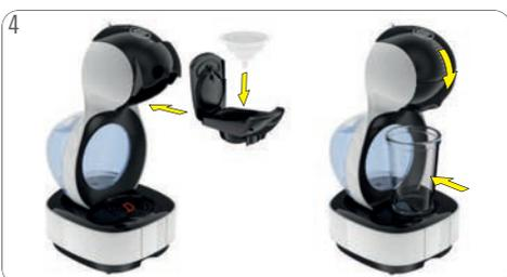
4 Abra la manija de bloqueo. Ponga la herramienta de enjuague dentro del soporte de la cápsula. Inserte el soporte de la cápsula en la máquina. Cierre la manija de bloqueo. Coloque un depósito grande vacío debajo de la salida de café.
