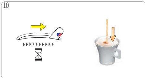
Empuje la palanca de selección a la posición "CALIENTE" o "FRÍA" como se recomienda en los packs de cápsulas. Se inicia la preparación de bebida. Espere hasta que la extracción finalice. La extracción puede detenerse manualmente en cualquier momento moviendo la palanca de nuevo a la posición «PARADA».
