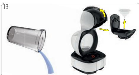
Retire el depósito. Vacíe y limpie el depósito. Retire el soporte de la cápsula. Retire la herramienta de enjuague. Guárdelo en un lugar seguro para su posterior limpieza o descalcificación. Enjuague el soporte de la cápsula con agua potable fresca por ambos lados. Vuelva a insertar el soporte de la cápsula.
