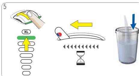
5 Ajuste el display de volumen al 7 con el selector de volumen. Empuje la palanca de selección a la posición "FRÍA". Se inicia el enjuague de la máquina.
