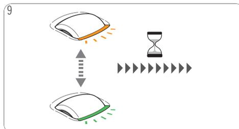
Para un mejor efecto del descalcificador, la máquina entra en un tiempo de espera de 2 minutos. Las luces del display de barras se apagan progresivamente.
