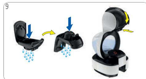
9 Enjuague el soporte de la cápsula con agua potable fresca por ambos lados. Seque el soporte de la cápsula. Insértelo de nuevo en la máquina. Disfrute de su bebida.
