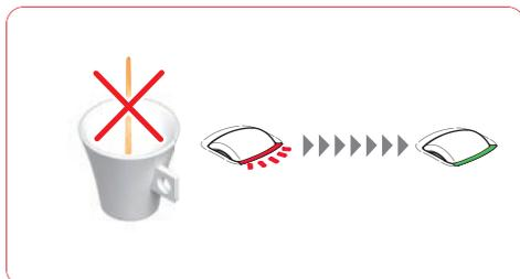
No sale líquido: la preparación de bebida se detiene parcialmente durante la dispensación o no llega a iniciarse. El display de volumen parpadea y la luz indicadora parpadea en rojo y verde rápidamente.
