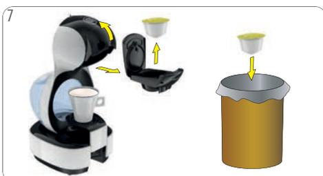
7 Abra la manija de bloqueo. Retire el soporte de la cápsula. Abra el soporte de la cápsula. Retire la cápsula usada. Ponga la cápsula usada en el depósito de desperdicios. Preste atención a no tirar el soporte de la cápsula.
