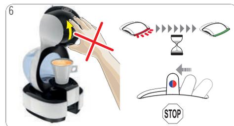
6 Después de terminada la preparación, la luz indicadora parpadea en rojo durante unos segundos y cambia a verde permanentemente. La palanca vuelve de nuevo a la posición «Parada». ¡No abra la manija de bloqueo durante este intervalo!
