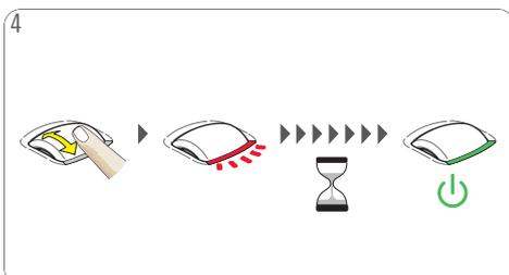
4 Encienda la máquina desplazando el selector de volumen. La luz indicadora comienza a parpadear en rojo mientras la máquina se calienta durante aproximadamente 40 segundos. A continuación, el indicador se ilumina permanentemente en verde. La máquina está lista para utilizarse.
