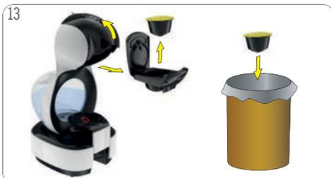
Abra la manija de bloqueo. Retire el soporte de la cápsula. Abra el soporte de la cápsula. Retire la cápsula usada. Ponga la cápsula usada en el depósito de desperdicios. Preste atención a no tirar el soporte de la cápsula.
