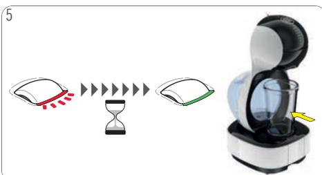
5 La máquina se enciende automáticamente. La luz indicadora comienza a parpadear en rojo mientras la máquina se calienta durante aproximadamente 40 segundos. A continuación, el indicador se ilumina permanentemente en verde. La máquina está lista para utilizarse. Coloque un depósito grande vacío debajo de la salida de café.
