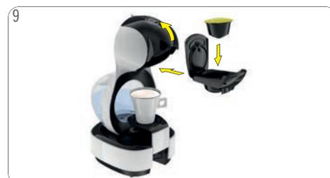
9 Inserte la segunda cápsula en el soporte de la cápsula. Cierre el soporte de la cápsula. Insértelo de nuevo en la máquina. Cierre la manija de bloqueo.
