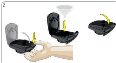
2 Tome el soporte de la cápsula y presione la pestaña de bloqueo para abrirlo. Asegúrese de que la herramienta de enjuague esté en el soporte de la cápsula. Cierre el soporte de la cápsula.
