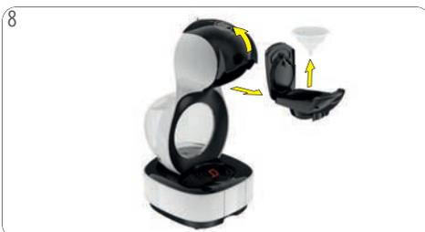
8 Abra la manija de bloqueo. Retire el soporte de la cápsula. Retire la herramienta de enjuague. Guárdelo en un lugar seguro para su posterior limpieza o descalcificación. Vacíe el agua que pudiera haber en el depósito de agua.
