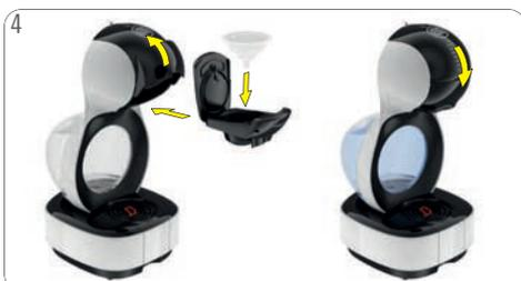
4 Abra la manija de bloqueo. Ponga la herramienta de enjuague dentro del soporte de la cápsula. Inserte el soporte de la cápsula en la máquina. Cierre la manija de bloqueo.
