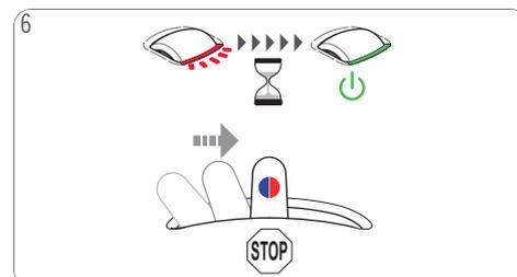
6 Espere hasta que el flujo de agua pare. La luz indicadora parpadea en rojo durante unos segundos y cambia a verde permanente. La palanca vuelve de nuevo a la posición «Parada».
