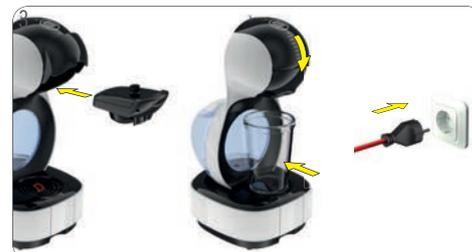
3 Inserte el soporte de la cápsula en la máquina. Cierre la manija de bloqueo. Coloque un depósito grande vacío debajo de la salida de café. Asegúrese de usar la tensión eléctrica correcta tal como figura en 2. «DESCRIPCIÓN GENERAL DE LA MÁQUINA» en la página 5. Conecte el enchufe de alimentación a la toma de corriente.
