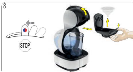
8 Espere hasta que la palanca se desplace a la posición "PARADA". Abra la manija de bloqueo. Retire el soporte de la cápsula. Abra el soporte de la cápsula. Retire la herramienta de enjuague. Guárdelo en un lugar seguro para su posterior limpieza o descalcificación. Vuelva a insertar el soporte de la cápsula.
