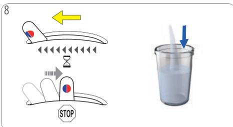
Empuje la palanca de selección a la posición "FRÍA". La máquina se descalcifica continuamente. La palanca se desplaza de nuevo a la posición central.
