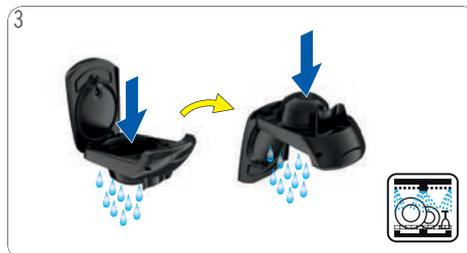
3 Limpie con líquido detergente y agua potable fresca ambos lados del soporte de la cápsula. Como alternativa puede lavarse en el lavavajillas. Séquelo a continuación.
