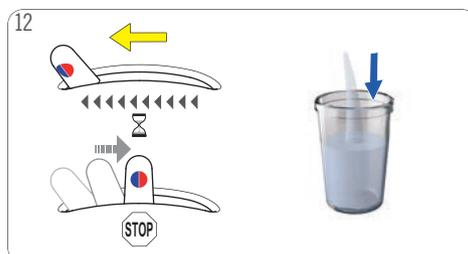
Empuje la palanca de selección a la posición "FRÍA". Espere hasta que la palanca se desplace a la posición "PARADA". El flujo de agua se para.
