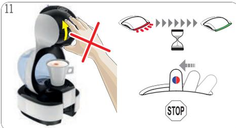
Después de terminada la preparación, la luz indicadora parpadea en rojo durante unos segundos y cambia a verde permanentemente. La palanca vuelve de nuevo a la posición «Parada». **¡No abra la manija de bloqueo durante este intervalo!**
