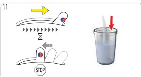
Empuje la palanca de selección a la posición "CALIENTE". Espere hasta que la palanca se desplace a la posición "PARADA". El flujo de agua se para.
