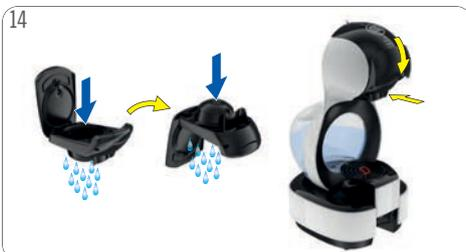
Enjuague el soporte de la cápsula con agua potable fresca por ambos lados. Seque el soporte de la cápsula. Insértelo de nuevo en la máquina. Disfrute de su bebida.
