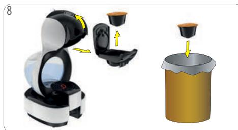
8 Abra la manija de bloqueo. Retire el soporte de la cápsula. Abra el soporte de la cápsula. Retire la cápsula usada. Ponga la cápsula usada en el depósito de desperdicios. Preste atención a no tirar el soporte de la cápsula.
