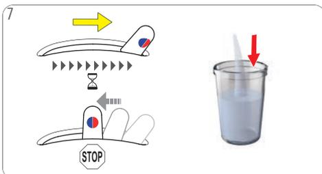
Empuje la palanca de selección a la posición "CALIENTE". La máquina se descalcifica en funcionamiento de inicio-parada durante aprox. 2 min. La palanca se desplaza de nuevo a la posición central.
