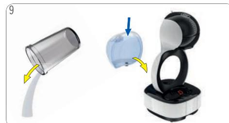
9 Vacíe el depósito. Llene el depósito con agua potable fresca. Inserte el depósito de agua en la máquina. La máquina está lista para utilizarse.
