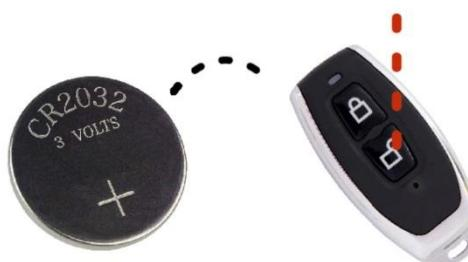
• **Mando a distancia:** La respuesta del mando será más lenta cuando la batería se esté agotando. Para realizar el cambio, separar las dos partes de la carcasa. Sustituir la batería. Ensamblar en el siguiente orden: carcasa frontal, circuito y carcasa trasera. Posteriormente, comprobar el funcionamiento (●●).
