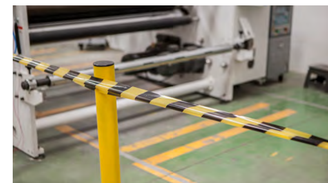
Marcaje y señalización de zonas peligrosas.
