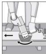
Conecte la herramienta eléctrica y asiente la parte anterior del soporte guía sobre la pieza. Desplace la herramienta eléctrica con un avance moderado adecuado al tipo de material a trabajar.
