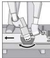
Después de desconectar el aparato no trate de frenar el disco de tronzar presionándolo lateralmente.
