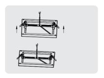
Paso 2: Instale el soporte en el aplique, introduciendo en las aberturas el soporte y empujando hasta que quede fijo.
