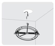
Paso 2: Conecte los cables del aplique a los de la corriente eléctrica.
