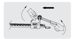
Estire hacia arriba las palancas interior y exterior. Desplace el carro hacia el interior.
