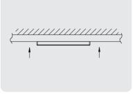
Paso 3: Instale el aplique en el soporte, introduciendo en las aberturas el soporte y empujando.
