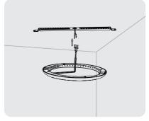
Paso 2: Conecte el cable a través del soporte al aplique.
