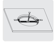
Paso 3: Instale el soporte en el techo, tirando de la palanca del muelle para que se quede ajustado al agujero.
