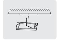
Paso 2: Conecte el cable a través del soporte al aplique.
