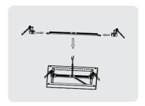
Paso 1: Coloque en la posición deseada los dos carros con muelle en el soporte, según el agujero en el techo y fíjelo.
