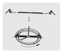
Paso 1: Coloque en la posición deseada las dos piezas con muelle en el soporte, según el agujero en el techo, instale el soporte en el aplique, girando 35°.
