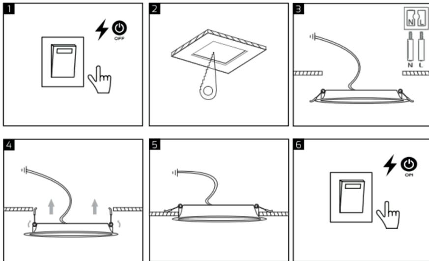
Confirme las dimensiones del contorno del accesorio y abra un orificio de corte en la superficie de instalación.
