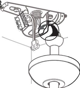
Cuelgue el ventilador de la placa de montaje. **Gire la rótula esférica hasta que la pestaña que sobresale de la placa quede alineada con la ranura de la rótula del ventilador.** El eje del ventilador debe quedar bloqueado sin posibilidad de girar libremente.
