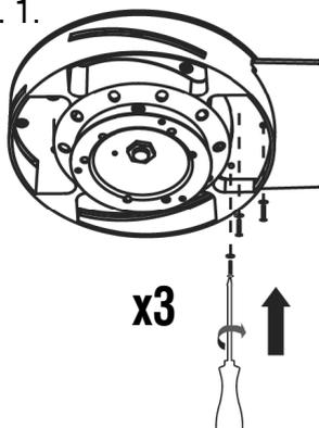
Montaje de las aspas: Coja una de las cuatro aspas suministradas y atorníllela al motor, tal y como se muestra en la imagen. Utilice para ello los 3 tornillos por aspa suministrados. Realice la misma operación con las 3 aspas restantes.
