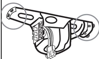
Sítúe la placa metálica de montaje en el techo, pase los cables eléctricos que vienen del techo por el lateral de la placa y marque la posición de los agujeros a realizar. Una vez realizados los orificios, fije dicha placa metálica utilizando los tacos/ tornillos/ arandelas adecuados al tipo de techo sobre el que va a instalar el ventilador. Verifique la correcta instalación de la placa antes de colgar el ventilador.
