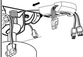
Inserte el receptor del mando a distancia en el hueco de la placa metálica existente entre el techo y la rótula esférica por la que ha colgado el ventilador.
