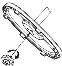
2. Desenrosque el pasador del tubo de extensión. Introduzca el tubo de extensión en la base y gírelo en el sentido de las agujas del reloj para ajustarlo. Apriete el pasador
