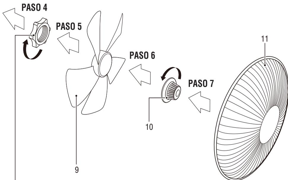
Fije la rejilla trasera con la tuerca (8) en sentido horario. Coloque a continuación la hélice (9) haciendo coincidir sus hendiduras con el eje del motor. Haga girar las aspas de la hélice para comprobar su correcta instalación y asegúrela con el cierre de seguridad (10). A continuación inserte la rejilla frontal (11) para terminar la instalación.
