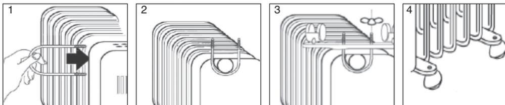
**ATENCIÓN:** Para fijar el soporte y las ruedas, voltear el radiador para trabajar cómodamente.
